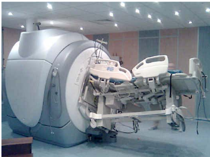
Rys. 3. Skutki oddziaływania pola magnetostaticznego silnego magnesu nadprzewodzącego tomografu rezonansu magnetycznego [serwis informacyjny Flying objects, www.simplyphysics.com/flying_objects.html ]
